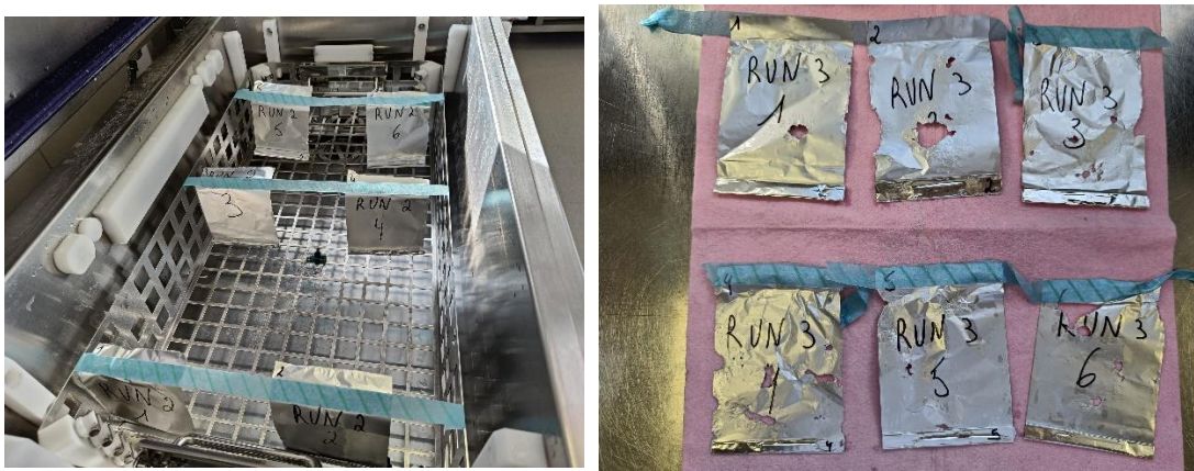
Schéma 5 : Visualisation de la perforation de bandelettes d'aluminium par les ondes ultrasoniques
