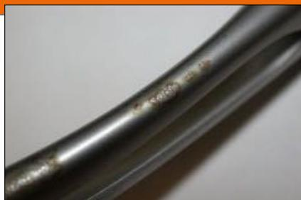
Dépôts de corrosion ou de rouille limités et dispersés au hasard
