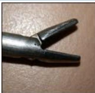
Effet des chlorures qui pénètrent dans la couche passive et provoquent ainsi une corrosion par piqûres.
