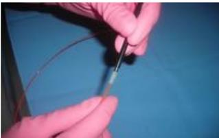
Si la configuration de l'instrument le permet, un nettoyage par traction est recommandé : insérer le côté sans brosse et tirer à travers
